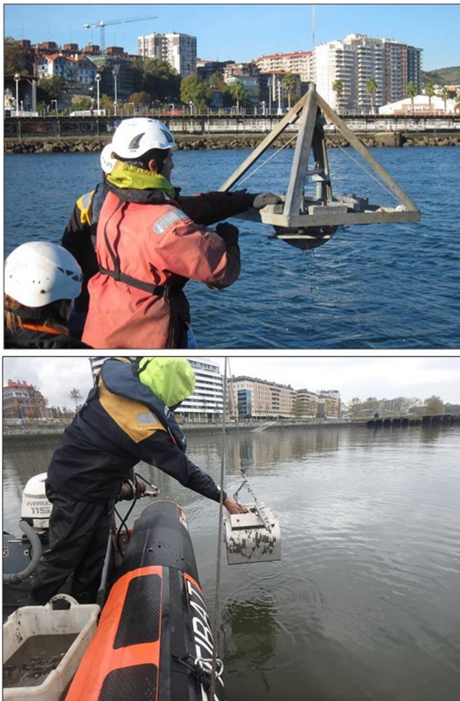
Fotografía 7.1. Dragas empleadas para el muestreo de sedimentos y bentos en el estuario del Nerbioi-Ibaizabal. En la imagen superior se observa la draga oceanográfica tipo “Day” y en la inferior, la draga oceanográfica tipo “Van Veen”.
