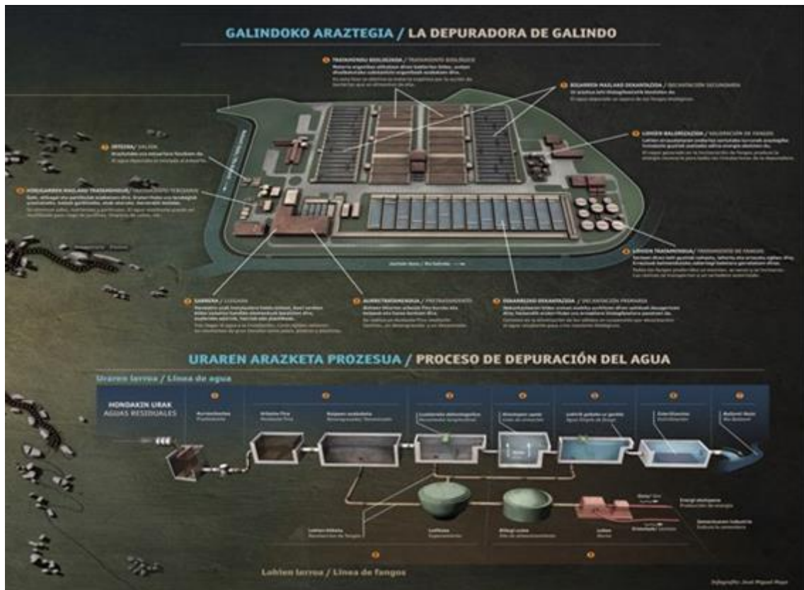
Figura 2.2. Estación depuradora de aguas residuales de Galindo (infografía de José Miguel Mayo, con información del CABB).
